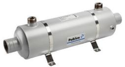
High-Flow zur Verwendung als Poolheizung für salzhaltiges und chlorhaltiges Schwimmbadwasser. Der rostfreie Wärmetauscher aus Titan erreicht eine Leistung von bis zu 35.500 kcal/h bei einer Vorlauftemperatur von 70/90°C.
